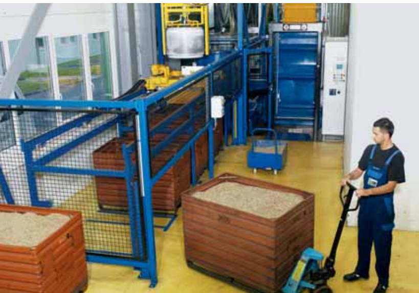
Mit der Umstellung auf ein einziges Schneidöl wurde auch die Ölrückgewinnung mit der vollautomatischen Spanzentrifuge vereinfacht.
