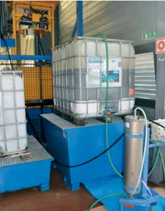
Das zurückgewonnene Schneidöl wird mit einer Filtrieranlage gereinigt und mit einem Anteil Frischöl den Werkzeugmaschinen zugeführt.
