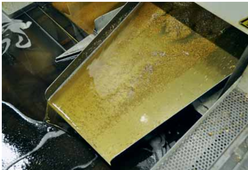
Bei BEC fallen im Produktionsprozess tonnenweise Späne an. Deren Recycling und die Rückgewinnung des ausgetragenen Schneidöls sind für die Kalkulation massgebend.
