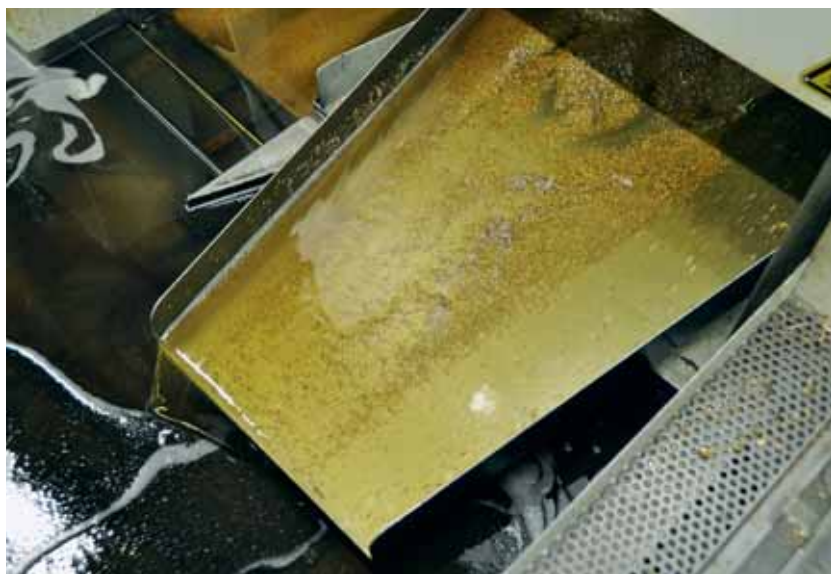
Presso la Binder Electronic Components, il processo di produzione genera tonnellate di trucioli, il loro riciclaggio ed il recupero dell'olio da taglio rientrano in linea dei conto nei calcoli.
