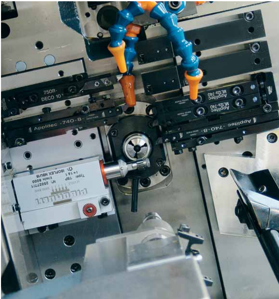
Die erfolgreiche Kinematik der Deco 10 mit vier unabhängigen, simultanen Werkzeugsystemen bleibt erhalten.
