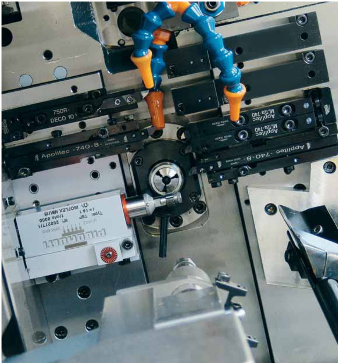
La cinemática de la máquina recupera la fórmula que hizo de la Deco 10 todo un éxito, es decir, 4 sistemas de herramientas independientes y simultáneos.
