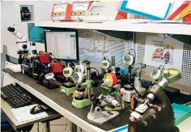
Dem Decolleteur steht eine ganze Armada von Messgeräten unmittelbar neben dem Drehautomaten zur Verfügung, um die Qualität der Drehteile sicher und effizient zu überprüfen.
