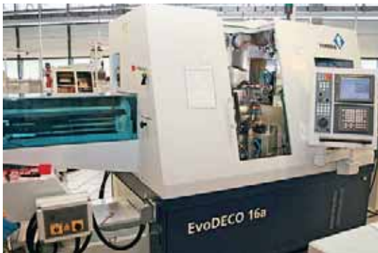
L'integrazione della parte superiore della macchina nella porta scorrevole libera completamente la zona di lavorazione. Questa caratteristica è molto apprezzata dagli operatori preposti alla tornitura.
