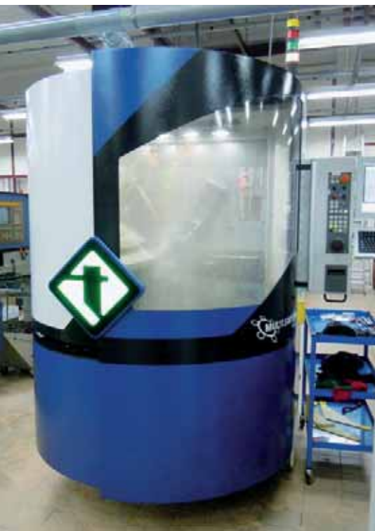
In termini di ingombro, MultiSwiss sostituisce molto semplicemente un tornio ENC.
