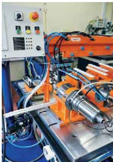
Prima del montaggio, ogni mandrino viene testato e «rodato». I risultati vengono conservati in un rapporto di prove e archiviati in base al mandrino corrispondente. I cuscinetti dei mandrini sono lubrificati con del grasso.
