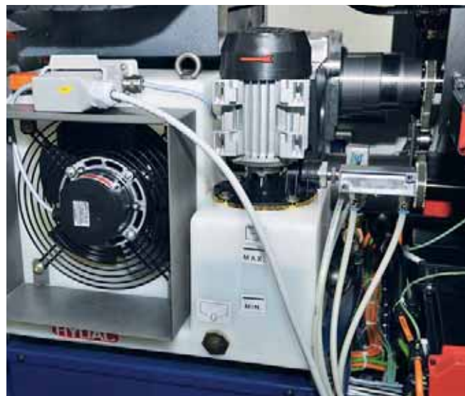
L'insieme del sistema di raffreddamento include sino a 20 litri di liquido refrigerante per mandrini. Il raffreddatore integrato dell'olio mantiene sempre la temperatura del fluido nel campo termico definito. La sorveglianza e la protezione del sistema vengono assicurate, se del caso, tramite dei sensori integrati.
