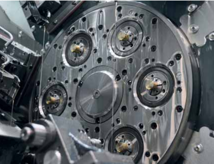
Das Herz der Maschine: Die Bearbeitungszone mit den 6 beweglichen Spindelstöcken. Dank dem Multiwerkzeugkonzept können bis zu 18 verschiedene Werkzeuge auf der Maschine montiert werden.
