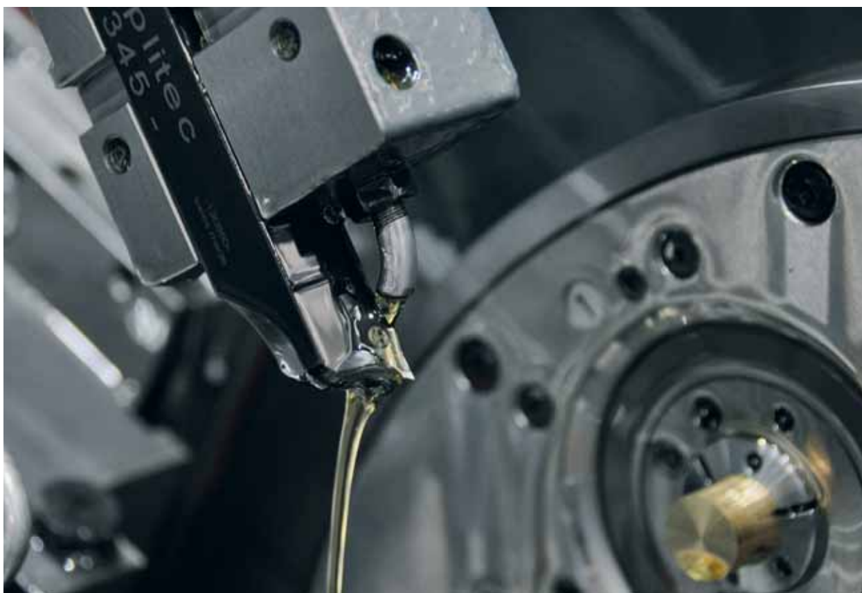
El portaherramientas del MultiSwiss 6x14 de Tornos cuenta por primera vez con una perforación para el lubricante y dirige el fluido de mecanización exactamente al punto más importante: entre el filo de la herramienta y la pieza.
