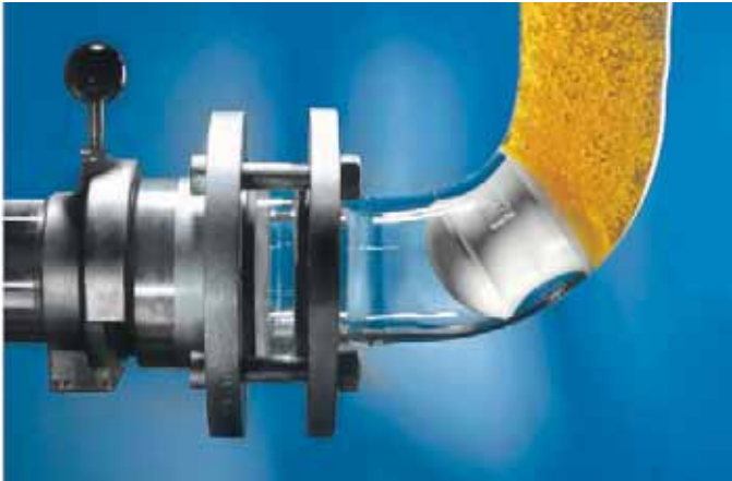
Durch das „Molchen“ sind aufwendige Spülvorgänge und dadurch längere Produktionsunterbrüche passé.
