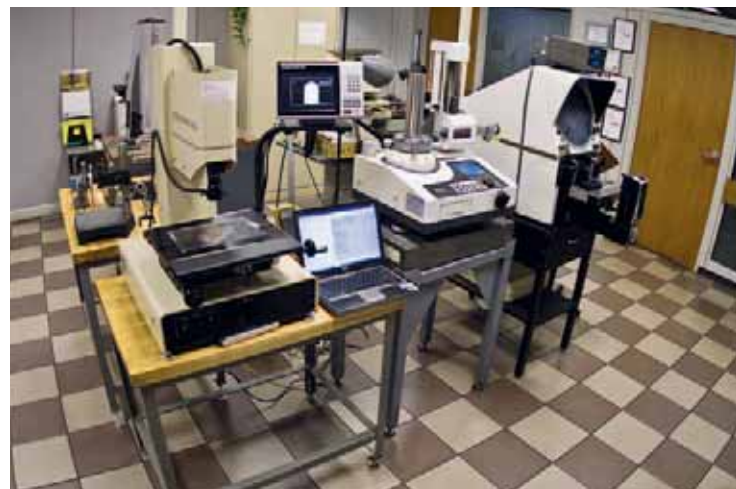
Os avanços do departamento de inspeção da DuAll incluem equipamento de varredura óptica rápida necessário para manter a alta produtividade e a precisão extrema das peças Tornos Swiss que estão sendo fabricadas na DuAll.
