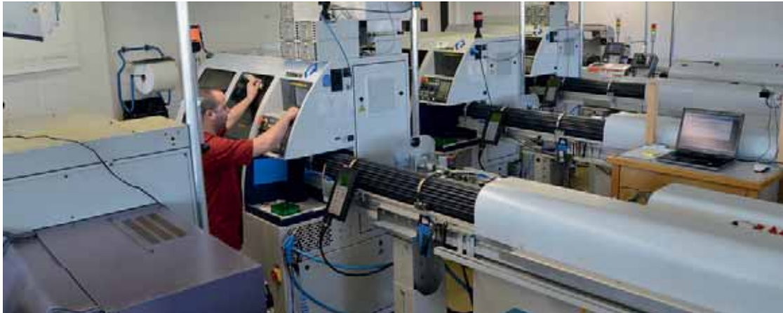
In der Werkstatt der Deco 10 arbeiten die Maschinen 18 Stunden pro Tag und 6 Tage die Woche in einer kontrollierten Umgebung. Toleranzbereiche von +/- 2 \mu sind hier üblich.
