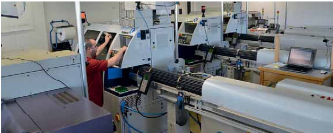
En el taller Deco 10, las máquinas trabajan 18 horas de 24 y 6 días de 7 en un entorno controlado. Ahí, las tolerancias de +/- 2 \mu están al orden del día.
