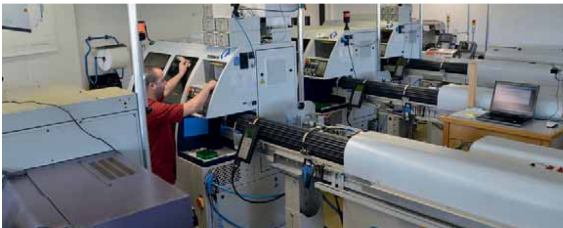
Nell'officina Deco 10, le macchine lavorano 18 ore su 24 e 6 giorni su 7 in un'atmosfera controllata. Tolleranze di +/- 2 \mu sono moneta corrente.
