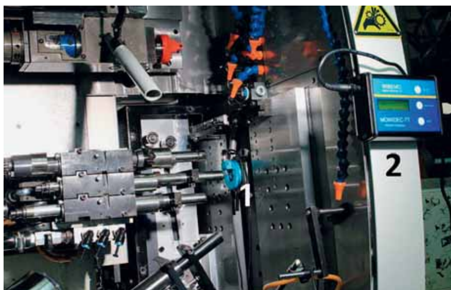
Mowidec-TT instalado em uma máquina Deco 10 da Tornos: 1) anel porta sonda e 2) indicador de controle. O cabo que conecta a sonda ao indicador suporta a atmosfera da zona de usinagem sem problemas.
