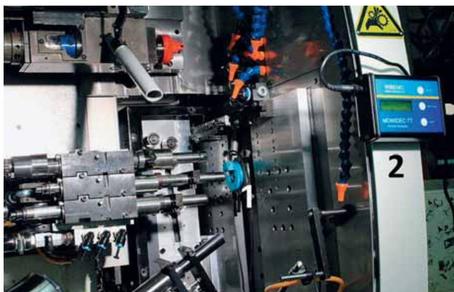
Mowidec-TT安装在Tornos Deco 10机床上：1)传感器轴承环和2)控制装置把传感器连接到本装置上的电缆能够承受加工区域的环境，没有任何问题。
