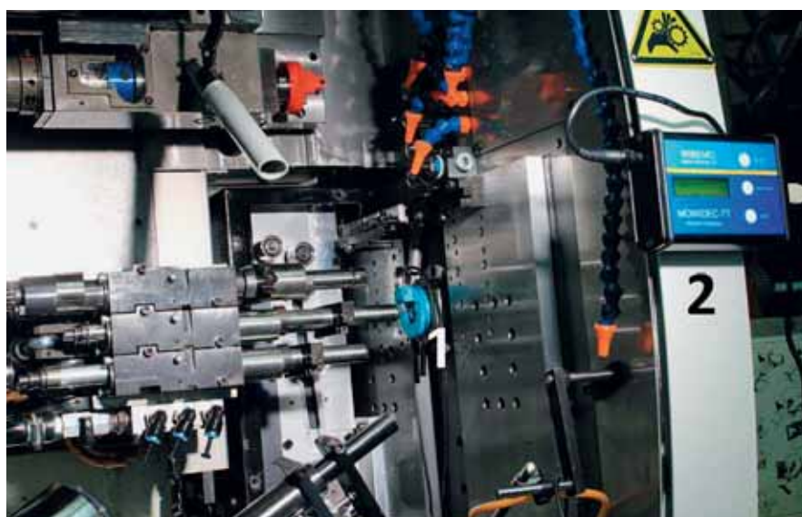
Mowidec-TT installato in una macchina Deco 10 di Tornos: 1) l'anello porta-sonda, 2) la base di controllo. Il cavo che collega la sonda alla base supporta, senza problema, l'atmosfera della zona di lavorazione.
