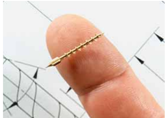
这个用于铜制纺织机上的长1.5厘米的高精度喷嘴轴，是在Tornos Deco 2000机床上紧接着一系列不锈钢零件后被加工完成的，它们同样使用的是Ortho NF-X切削油。
