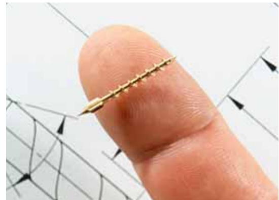
Este eje pulverizador de alta precisión, de latón y de aprox. 1,5 cm de longitud para una máquina textil, se fabricó justo después de una serie de piezas de acero inoxidable con el mismo aceite de corte (Ortho NF-X) en una Deco 2000 de Tornos.
