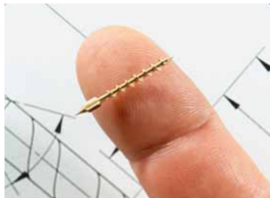
Questo albero di alta precisione, lungo 1,5 cm, destinato ad un polverizzatore per macchine tessili, è in ottone ed è stato realizzato su una Tornos Deco 2000 a cui, subito dopo, ha fatto seguito una serie di particolari in inox, con un solo e medesimo olio da taglio (Ortho NF-X).
