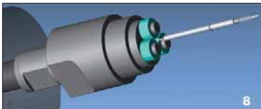
Roscado por rodadura.
