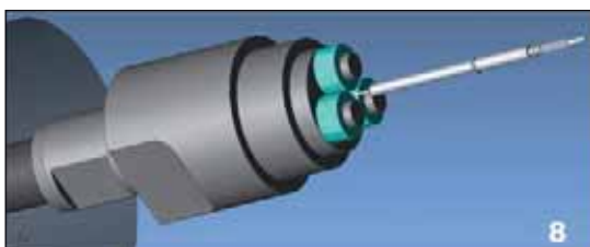
Filetage par roulage.
