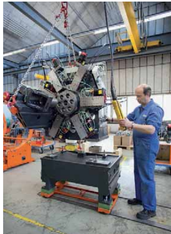
Hier wird in der Montage der Mehrspindelblock mit dem Chassis aus Spezialguss „verheiratet“. Generell ist die Herstellung einer Tornos MultiSwiss aus mechanischer und elektrischer Sicht eine Meisterleistung.
