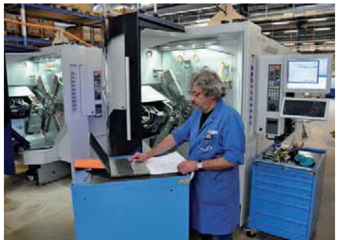
Hier überprüft ein Fachmann die Geometrie einer Tornos MultiSwiss 6x14. Ohne Computer und eigens entwickelte Software wäre dies nicht zu realisieren.
