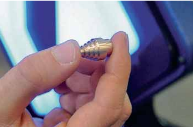
Mehrere Kleinserien verschiedenster Testteile werden auf jeder neuen Maschine hergestellt und danach exakt vermessen.
