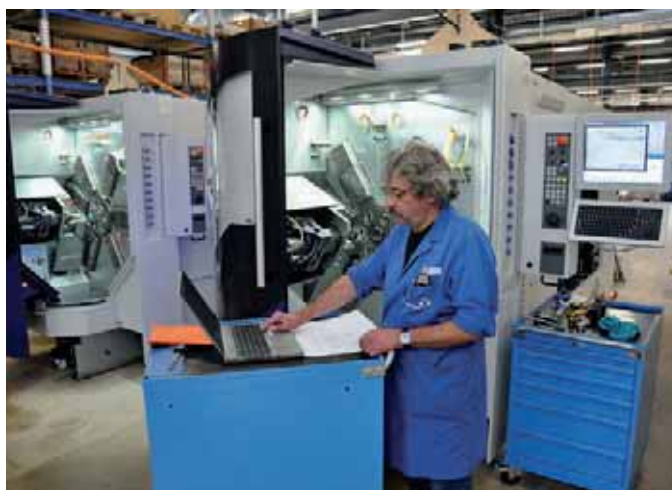
Aquí, un especialista está comprobando la geometría de una MultiSwiss 6x14 de Tornos. Sin un ordenador ni el software desarrollado por la empresa no sería posible llevar la comprobación a cabo.
