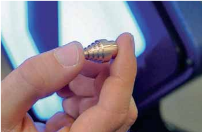
En cada máquina nueva se producen diversas series pequeñas de distintas piezas de prueba y, posteriormente, se miden con precisión.
