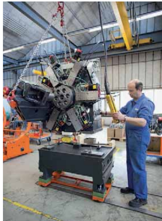
Aquí se están uniendo el montaje del bloque multihusillo con el chasis de fundición especial. Por lo general, la fabricación de una máquina Tornos MultiSwiss es una obra maestra desde el punto de vista mecánico y eléctrico.
