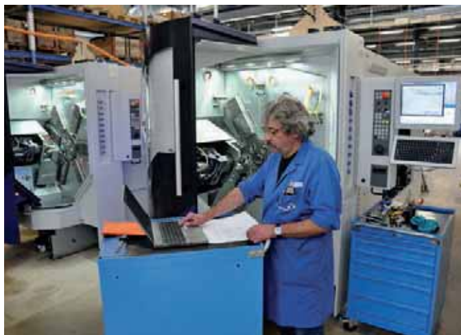
Uno specialista controlla la geometria di un tornio MultSwiss 6x14. Questa tappa non sarebbe realizzabile privi di un computer e dei soft aziendali.
