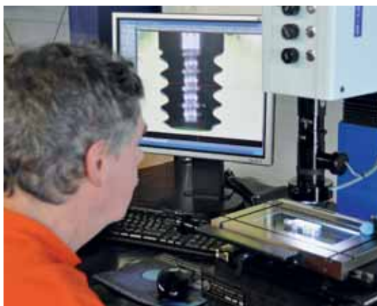
Com a mais moderna técnica de medição, as peças estão sujeitas à medição óptica e os valores são avaliados com o sistema de controle de qualidade com o software QuickControlPro®.
