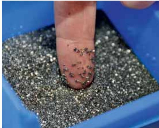
A olho nu, a grande quantidade de peças de precisão torneadas para a indústria relojoeira como, por exemplo, estes parafusos de 1,19 mm de comprimento para mecanismos de relógios quase não pode ser reconhecida.
