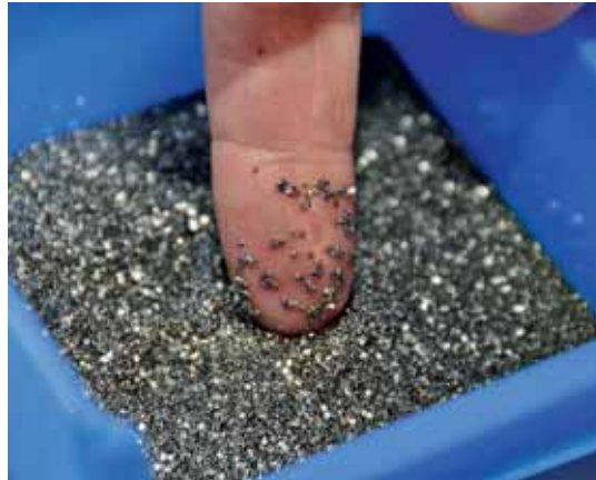
Von bloßem Auge sind viele Präzisionsdrehteile für die Uhrenindustrie wie diese nur 1,19 mm langen Schrauben für mechanische Uhrwerke kaum zu erkennen.
