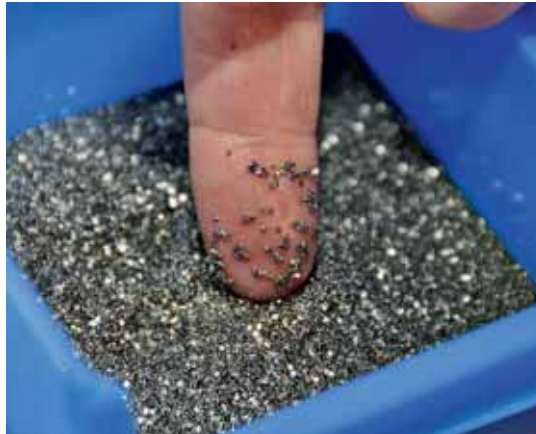
A simple vista, muchas piezas torneadas de precisión para la industria relojera, como estos tornillos de tan solo 1,19 mm de longitud para trabajos de mecanizado relojero son prácticamente inapreciables.
