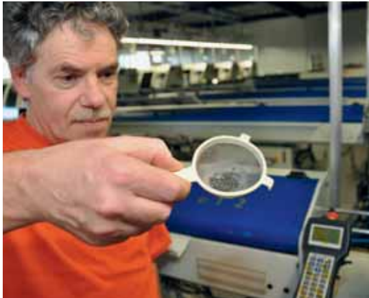
Un encargado de la calidad de Easydec recoge en una máquina un muestra de los tornillos que hay que medir.
