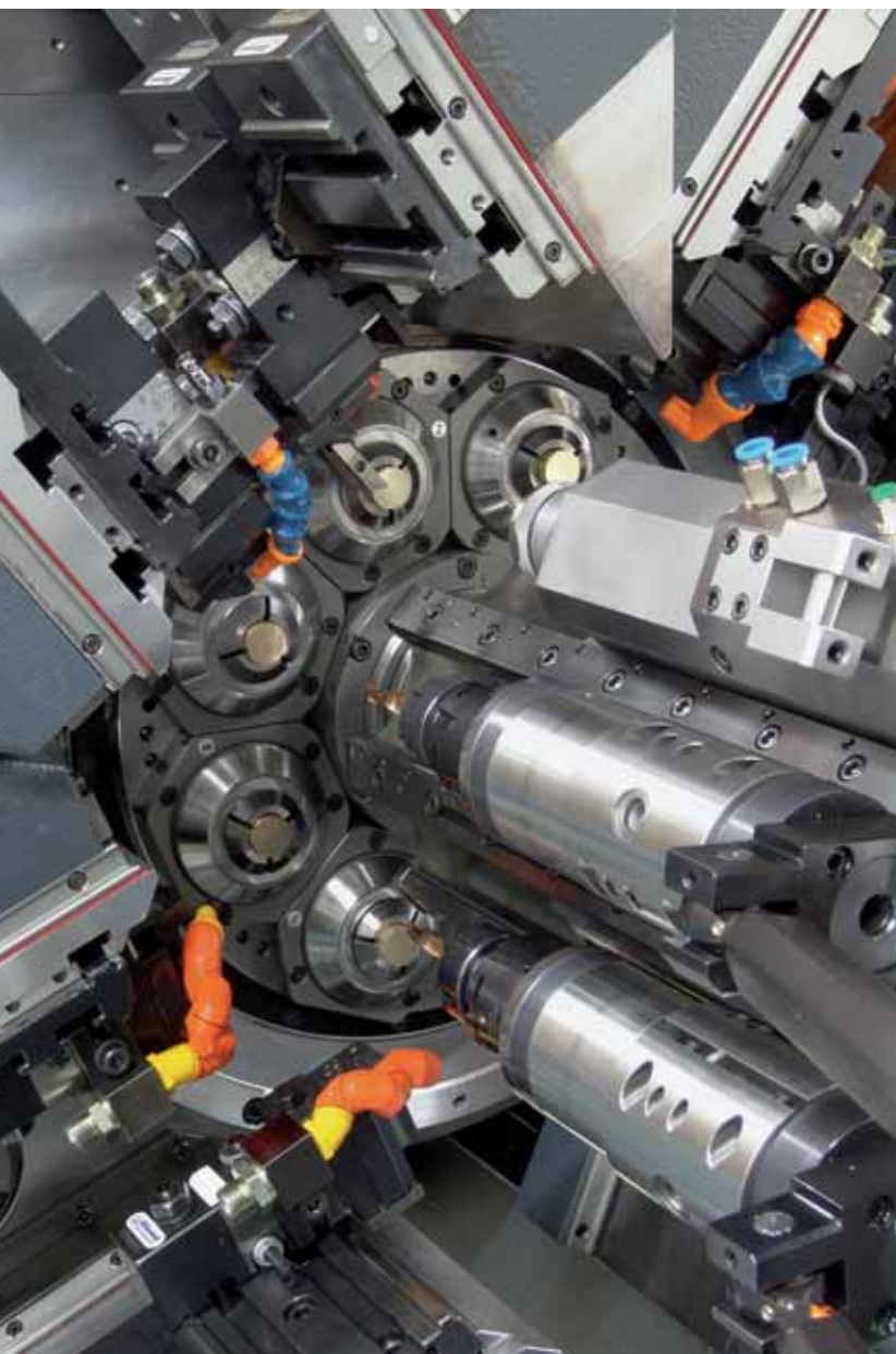
A área de usinagem da MultiSigma. As ferramentas são monitoradas de modo confiável com o CTM V6 da ARTIS, garantindo os processos.
