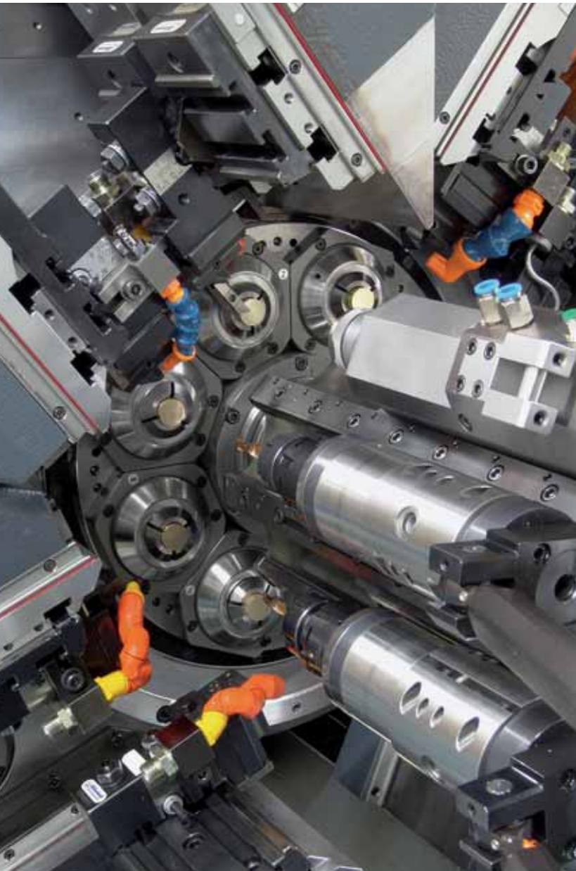
Área de torneado de MultiSigma. El sistema CTM V6 de ARTIS supervisa las herramientas de forma fiable y confiere seguridad a los procesos.
