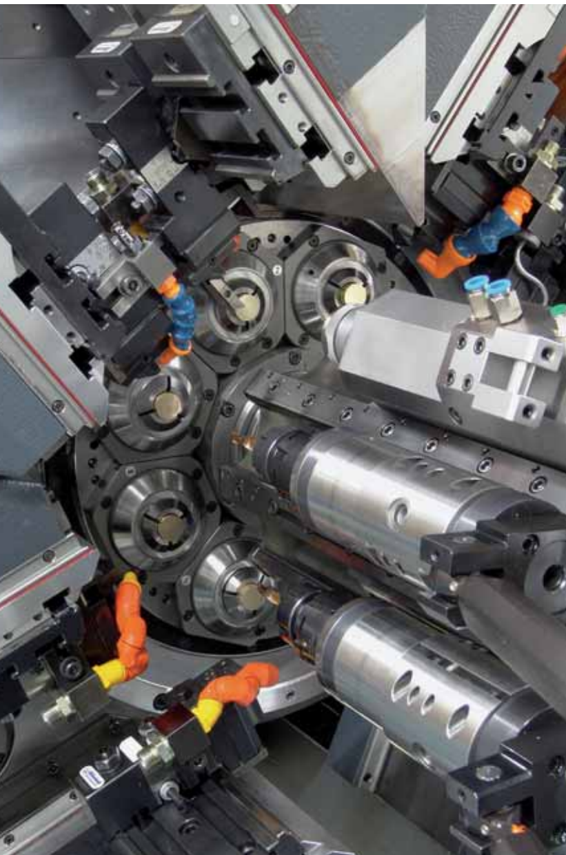
L'espace d'usinage du MultiSigma. Grâce au CTM V6 d'ARTIS, les outils sont surveillés de manière fiable et les processus sont ainsi sécurisés.
