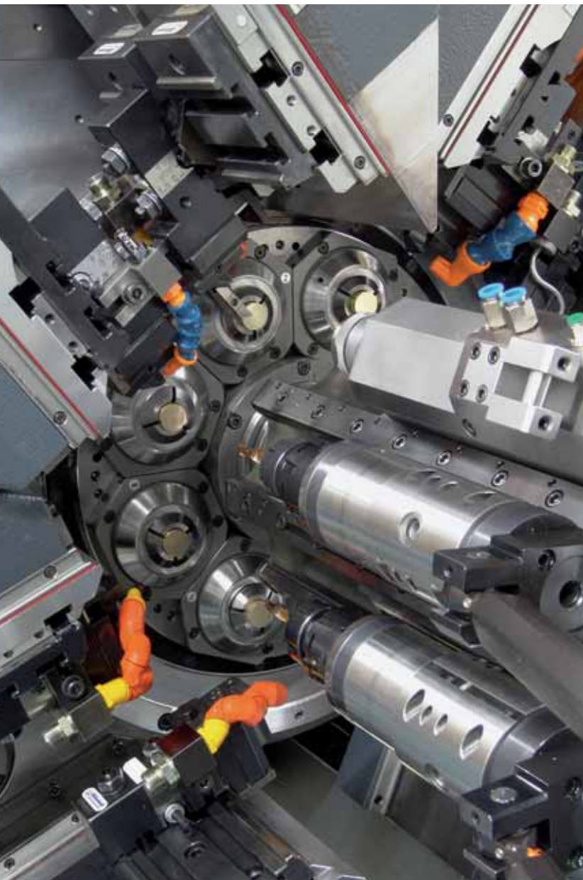
L'area di lavorazione del MultiSigma. Grazie al CTM V6 di ARTIS, gli utensili sono sorvegliati efficientemente, fattore che rende sicure le operazioni.
