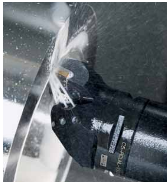
Das Drehen mit präzise ausgerichteten Kühlmittelstrahlen hat seit einiger Zeit in unterschiedlichen Bearbeitungsbereichen wegweisende Entwicklungen erfahren. Heute gilt diese Technologie nicht nur als Problemlösung, sondern als eine Methode zur tatsächlichen Leistungsoptimierung bei der Herstellung zahlreicher Teile in der Medizintechnik. Das Konzept des CoroTurn QS-HP vereint schnellen, sicheren Werkzeugwechsel mit der Anwendung eines Hochdruck-Kühlschmiermittels beim Drehen kleiner Teile.
