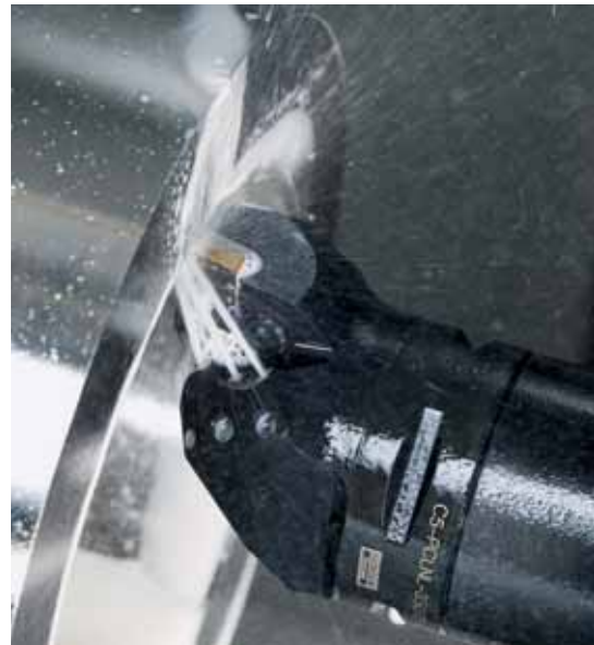
El torneado con chorros de refrigerante de gran precisión ha sido sometido a grandes desarrollos, a lo largo de los últimos años, en varias aplicaciones de mecanizado. La tecnología se considera ahora no sólo un medio para resolver problemas sino también un medio para optimizar considerablemente el rendimiento para una serie de piezas del sector médico. El concepto CoroTurn QS HP combina el cambio rápido y seguro de la herramienta con la aplicación de refrigerante de alta presión para el torneado de piezas pequeñas.
