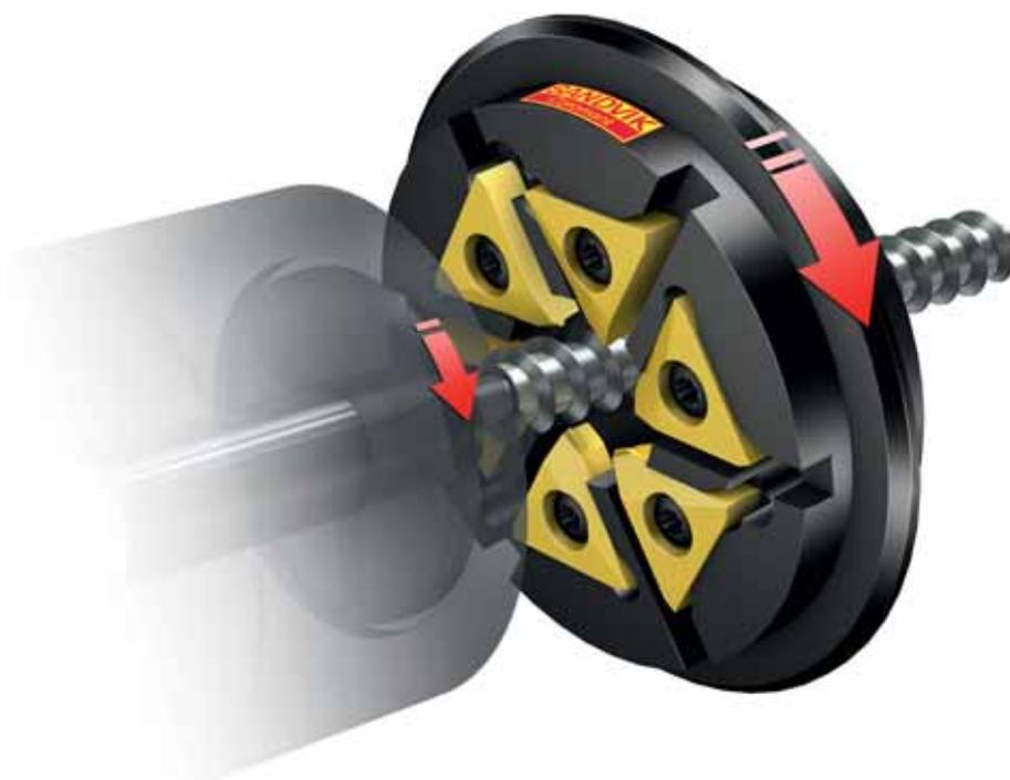
Gli utensili recentemente sviluppati, come il turbofilettatore CoroMill 325, hanno reso ancora migliore un vantaggioso metodo di generazione dei filetti. La fresatura con turbofilettatore è un modo efficiente, affidabile e preciso per eseguire i filetti. La nuova costruzione dell'utensile e gli inserti multitaglienti offrono notevoli vantaggi per i componenti quali le viti ossee.
