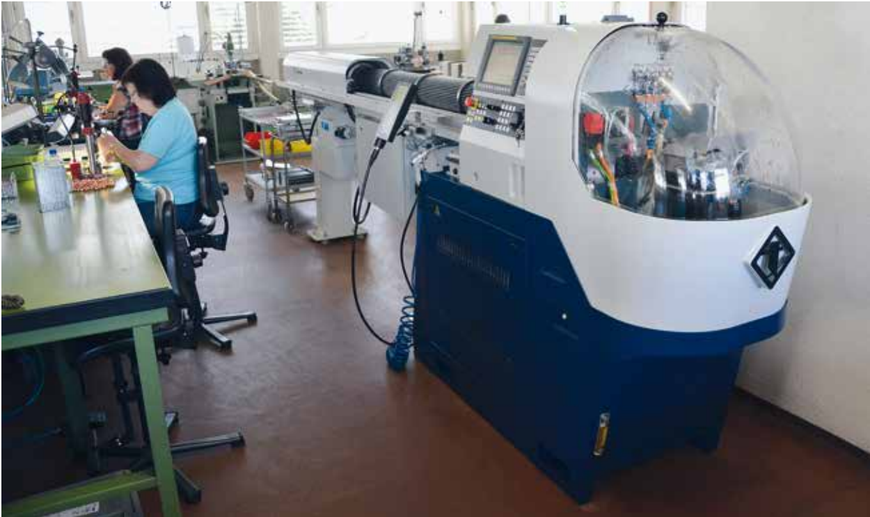
出于测试的目的，SwissNano机床被安装在远离棒料车削车间的地方。其紧凑的尺寸和设计可以安装在任何车间内。因为不能从后部接近，所以可以靠墙安装。
