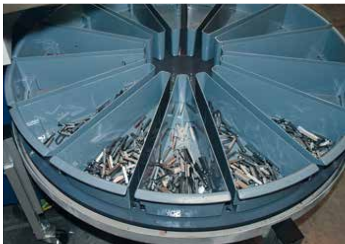
Il sistema di ordinamento da quindici vasche di Performance Design accoglie un set di mandrini Rhin-o-Tuff completo (lo stesso mandrino di quindici lunghezze differenti).
