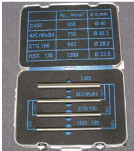
Dank höherer Festigkeiten halten der ETG® 100 und der HSX® 130 im Gegensatz zu Standardvergütungsstählen auch großen Belastungen bei einem geringeren Wellendurchmesser stand.
