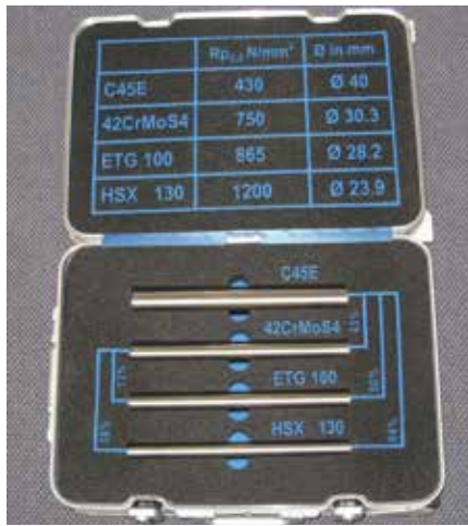
Gracias a las resistencias superiores, el ETG® 100 y el HSX® 130 soportan también grandes cargas con un diámetro de árbol más pequeño a diferencia de los aceros templados estándar.
