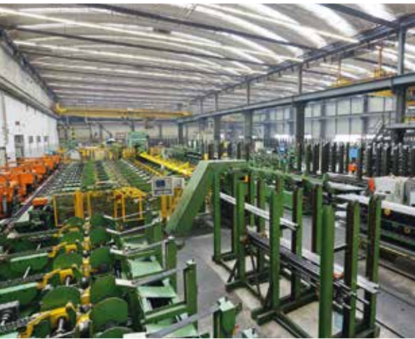
Sur une installation de production en continu, les aciers HSX® sont, selon les exigences, étirés, écroutés et rectifiés.
