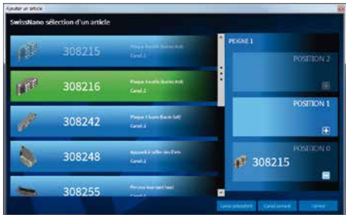
选择SwissNano上的刀具，不可用的刀具为灰色。已安装的刀具显示为深蓝色，用户看到的解决方案是一个表示同意的向上竖起的大拇指！
