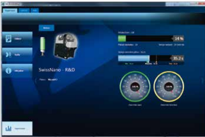
机床实时监控的详细状态和生产状况监控。也可以显示当前工件的图纸。
