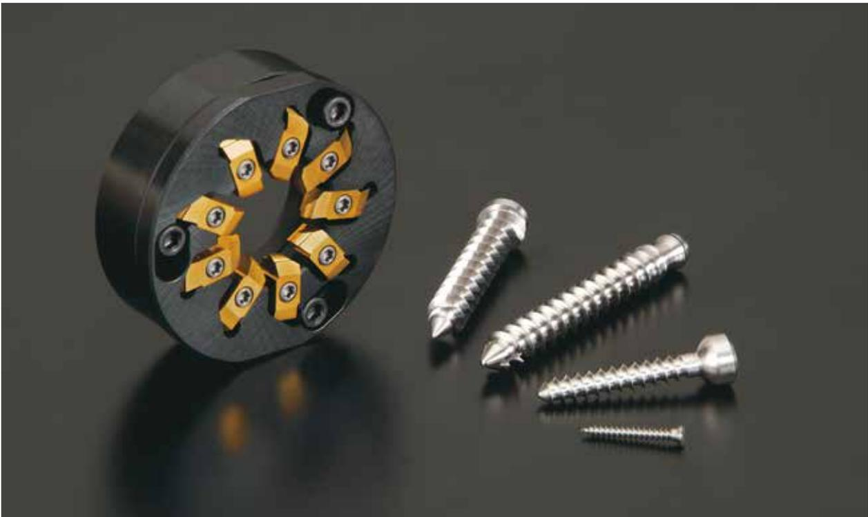
NTK hat schon 2008 die ersten Gewindewirbelwerkzeuge mit 9 Wendepetten auf den Markt gebracht. Aus Sicht der Ingenieure von NTK war das Gewindewirbeln nie ein komplizierter Prozess. Die Schwierigkeit lag für sie nicht in der Bearbeitung, sondern in der Herstellung eines Gewindes, dessen Form genau der Planvorgabe entspricht.
