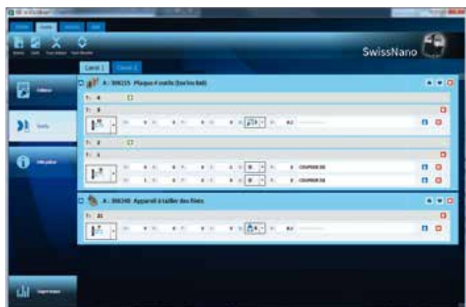
ISIS propondrá geometrías de herramientas predeterminadas y el usuario será libre de corregirlas en caso necesario.
