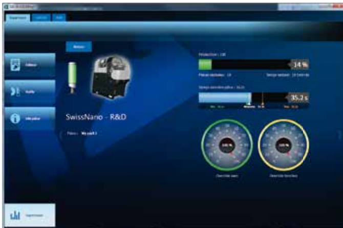
Monitoring détaillé d'une machine en temps réel et surveillance de l'état de la production, le dessin de la pièce en cours peut par exemple aussi être visualisé.
