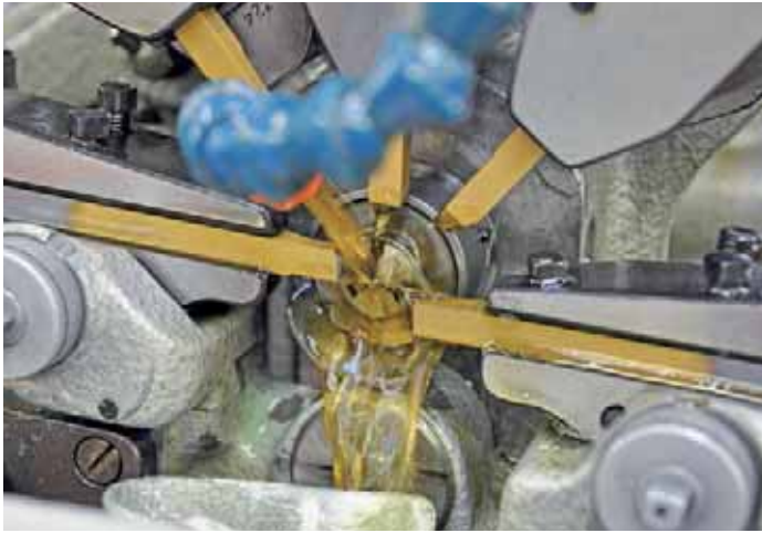
切削液的选择直接影响刀具的加工效率和使用寿命。
