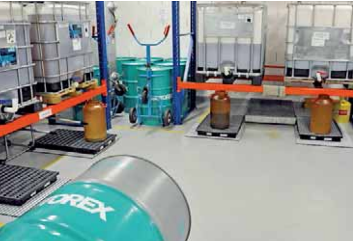
Im Ölersorgungsraum werden nicht nur die Schmierstoffe gelagert, sondern auch Späne geschleudert und Bearbeitungsfluids filtriert.
