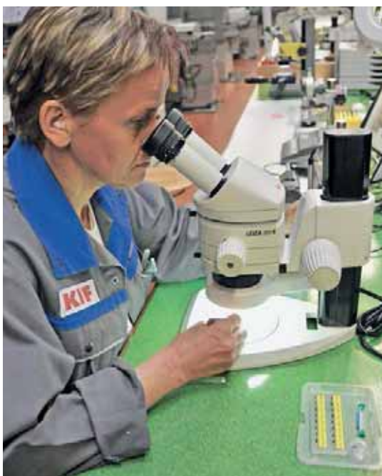
Mittels modernster Messtechnik werden die Teile vermessen und die Werte über das Qualitätskontrollsystem ausgewertet.
