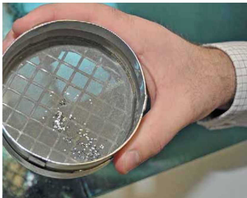
Von blossen Auge sind die filigranen Präzisionsdrehteile für die mechanischen Uhrwerke kaum zu erkennen.
