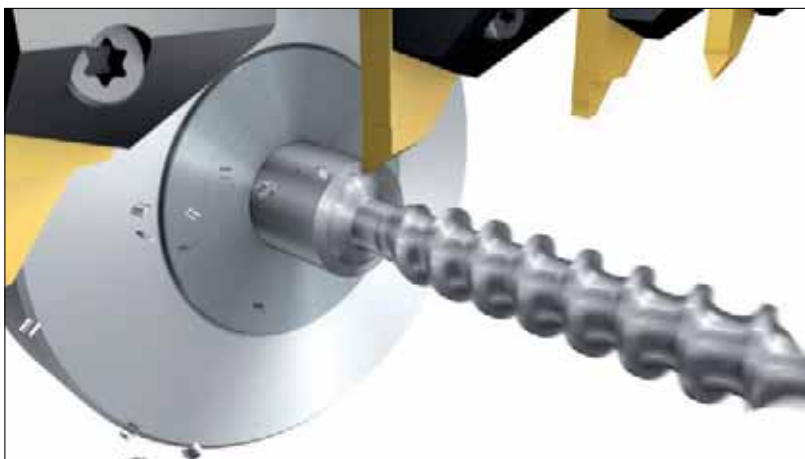
骨科螺钉属于细长的钛合金部件，其螺纹加工过程需要特别安全高效，以便获得高质量的零部件。螺纹旋风铣是一种高效可靠的完美工艺，能够避免弯曲和振动趋势。正确选择刀具、切削参数、编程以及刀具设置，对获得最佳的结果和更高的生产效率而言至关重要。
