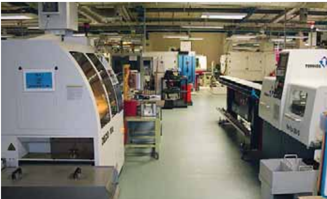
Las máquinas Deco 10a y Delta 20/5 en funcionamiento para la fabricación de piezas de producción y de desarrollo.
