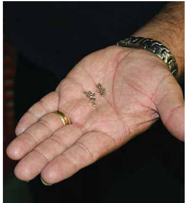
Primo piano sulla mano del Signor Steve Somers che espone degli ugelli in ottone da 2 mm che sono installati sui mandrini ad alta frequenza.
