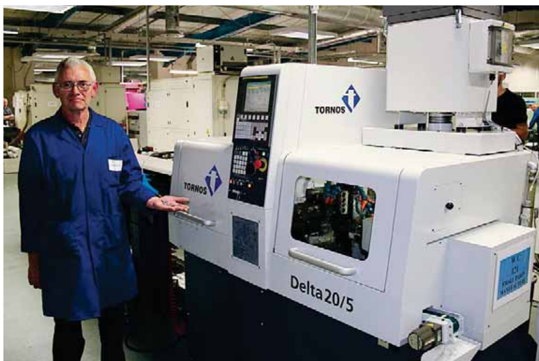
Il tornio Delta 20/5 e il suo operatore che mostra delle viti, dei rivetti, dei restringitori e dei particolari di sviluppo fabbricati sulla Delta.
